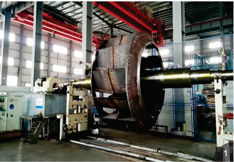
1 德国申克动平衡机 GERMANY SCHENCK DYNAMIC BALANCING MACHINE
