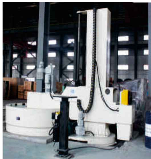
超速试验台 Overspeed test bench
