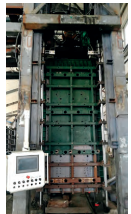
图11 自动拆模平台
